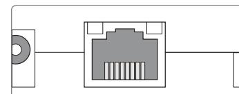
El puerto LAN integrado se sitúa en la parte delantera del módulo de comunicación KM2 y admite velocidades de transmisión de hasta 100 MBit por segundo.
