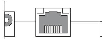
Die LAN-Buchse befindet sich an der Vorderseite des Kommunikationsmoduls KM2 und unterstützt Transferraten von bis zu 100 MBit pro Sekunde.
