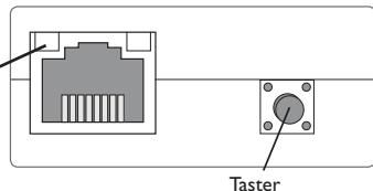
→ Um das Kommunikationsmodul KM2 über WPS mit dem Router zu verbinden, den Taster für ca. 5 s gedrückt halten.
