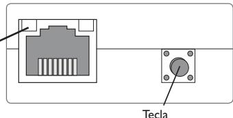
→ Para conectar el módulo de comunicación KM2 mediante WPS al router, mantenga pulsada la tecla durante aprox. 5 segundos.
